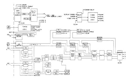
Figure  $\mathbf{\mu}$ VIDEO CONTROLLER CHIP BLOCK DIAGRAM
