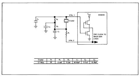
FIGURE 4. TYPICAL CRYSTAL OSCILLATOR NETWORK
